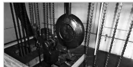
*Das Uhrpendel mit dem neuen Linearmotor und der Magnetplatte zum anhalten*
