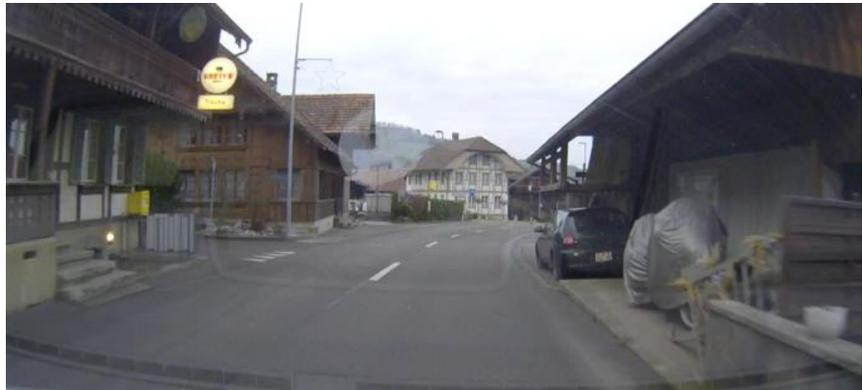
**Ausgangslage** Fehlende Sichtweiten Ausfahrt Traubengasse, Abgang Treppe Rest. Traube führt direkt auf Kantonsstrasse, ungenügende Sichtweiten Ausfahrten Restaurant Traube, fehlende FV-Längsverbindung von Bushaltestelle auf Blumensteinstrasse südwärts. DTV Blumensteinstrasse = 3'000, 1 registrierter Unfall.
