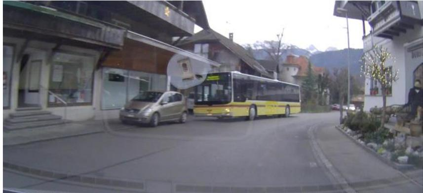
**Ausgangslage** Bushaltestelle wird von STI für Ausgleichszeiten benützt, deshalb z.T. lange Stehzeiten von zwei Bussen gleichzeitig. Dies führt zusammen mit senkrecht parkierten und retour auf die Strasse manövrierenden Autos und der allenfalls besetzten Postautohaltestelle vis à vis für den Velo- und Fussverkehr zu kritischen Situationen.
